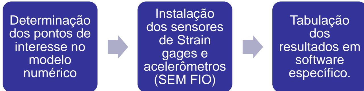
**Com esta metodologia elimina-se as extrapolações de ciclos (“chutes”) e a previsão de vida útil a fadiga torna-se mais próxima a realidade estrutural.**
